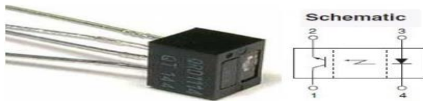
Fig. 1 sensor infrarrojo QRD1114 y su esquemático
