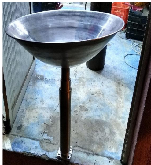
Imagen 9. Resultado del concentrador posterior al proceso de repujado.
