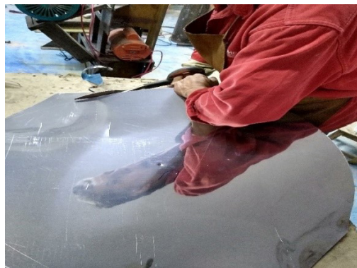
Imagen 3. Proceso de corte de Lámina para Repulsado. Nota: El trabajo se Traslada a un taller de Acero Inoxidable para su mejor elaboración, las imágenes son capturadas por el autor Eduardo Bello Sánchez.
