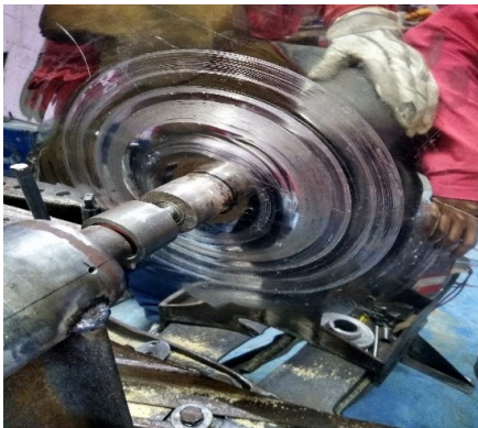
Imagen 4. Problemáticas del modelado y proceso de Repujado. Nota: El Proceso se llevó a cabo sobre un torno modificado para el tamaño del concentrador; la imagen es capturada por el autor Eduardo Bello Sánchez.
