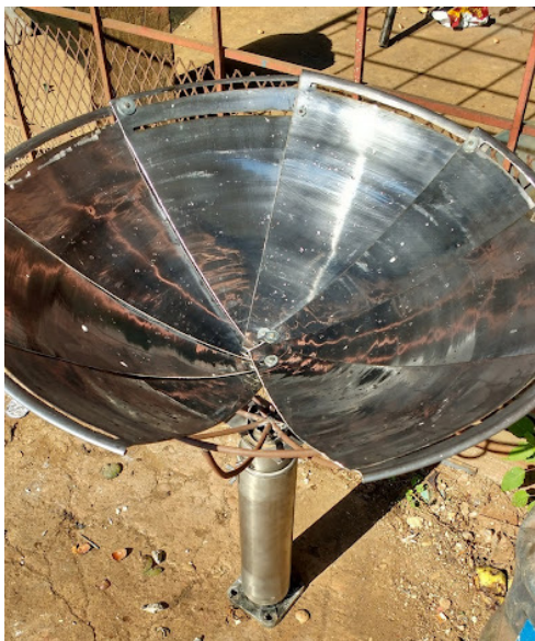
Imagen 10. Sistema de concentración con el nivel especular alto.
