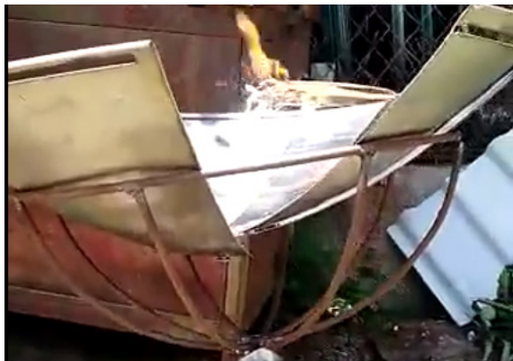
Imagen 7. Prueba del funcionamiento del concentrador solar. Nota: Se captura el funcionamiento preliminar de captación
