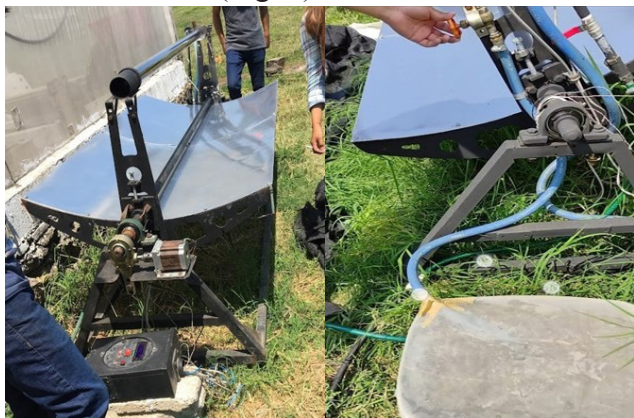
Figura 1. Concentrador cilíndrico parabólico (CCP) diseñado para su valoración en este estudio.
