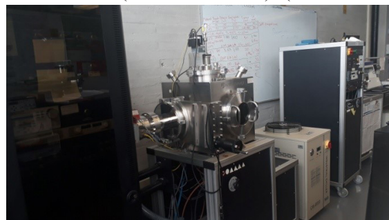
Ilustración 1. Sistema de erosión catódica magneto planar en su modo de radio frecuencia Sputtering
