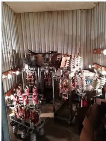
Figura 2. Interior del cuarto con res-tauradores y cartones aislantes (Fotografía tomada en el taller eléctrico)
