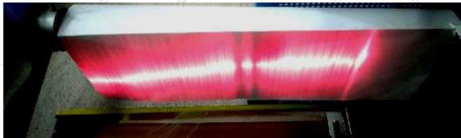
Ilustración 6. Trayectoria lineal del láser reflejado en el patrón sobre el tubo concentrador visto desde la cámara.
